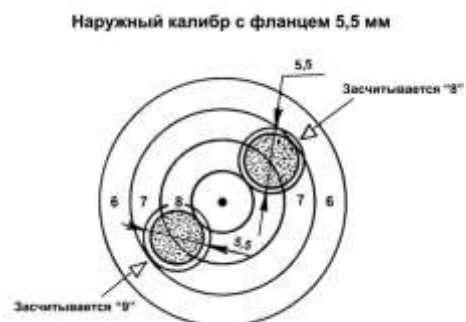
Рис. 2. Применение наружного калибра для определения достоинства пробойны в стрельбе из пневматической винтовки.
